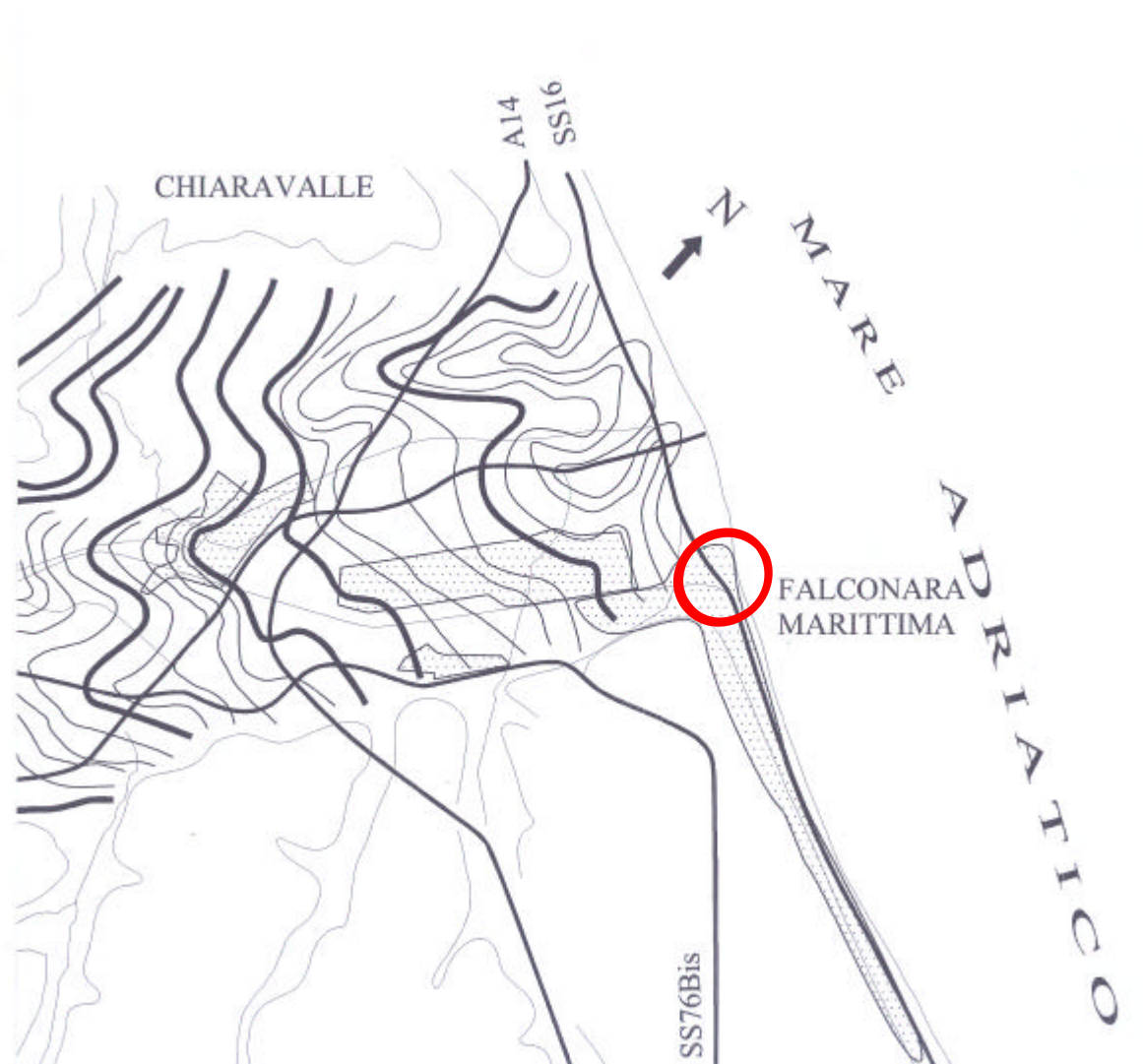
Fig. 4 - Piezometria dell'acquifero di subalveo nella pianura costiera del fiume Esino relativa al 1986. Le linee spesse hanno un'intervallo di cinque metri. Nell'ovale è ubicato l'abitato di Villanova di Falconara Marittima.
